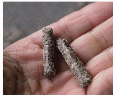
発電に使う燃料の木質ペレット=徳島市のバイオマス発電所で2024年1月
